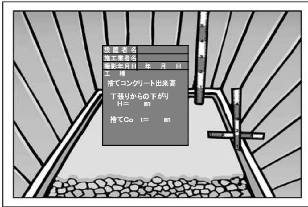
写真(捨てコンクリート打設状況 例1)
