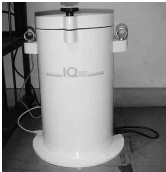
東原庁舎に設置の食品等放射性物質検査機器
