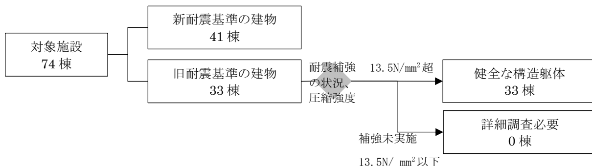
図 3-14 構造躯体の健全性の評価結果
