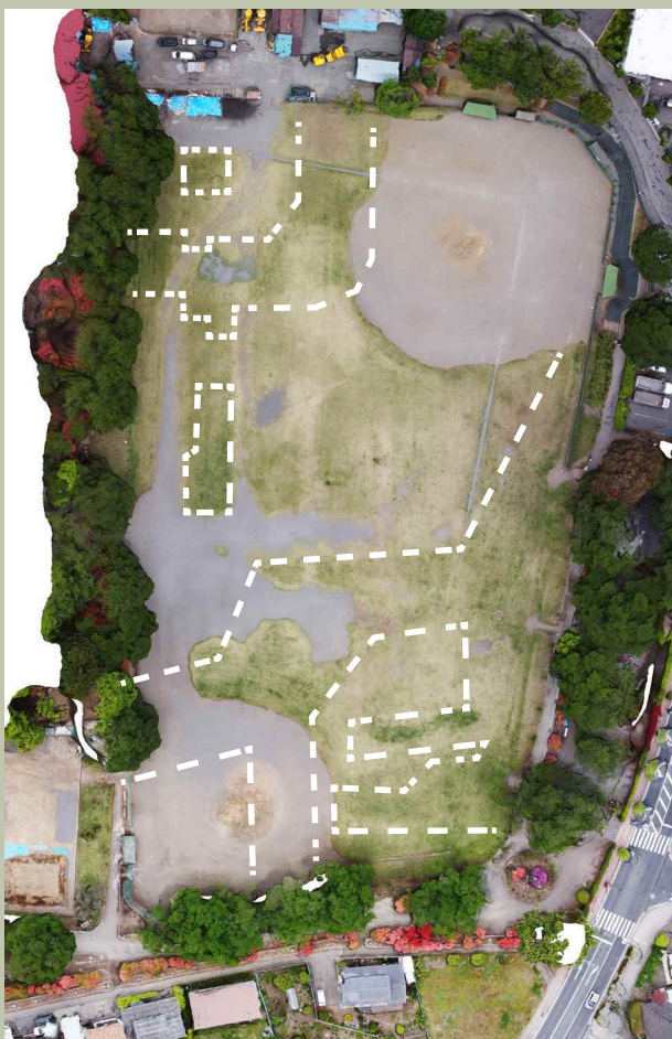
6ページの地中レーダー探査結果を重ねたもの With Results of GPR
